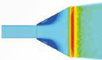
Simulazione del flusso con sistema di insufflazione ottimizzato
