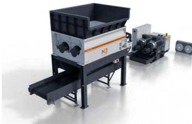
Versione con trasmissione idraulica
