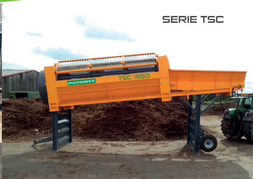
> La serie TR è dotata di: telaio su ruote, tramoggia di alimentazione con fondo scorrevole in gomma, tamburo di vaglio, due nastri di scarico per le frazioni ottenute dalla vagliatura.
