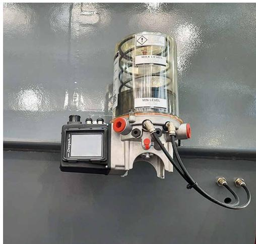
► **Centralina e serbatoio per lubrificazione centralizzata**
