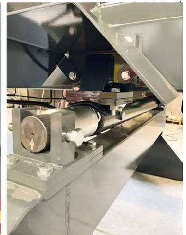
► **Dettaglio della cella di carico per la rilevazione del peso**
