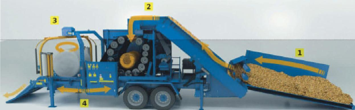
**1** Un'ampia tramoggia (volume circa 13 mc e larghezza 3.500 mm) permette il carico del materiale in svariati modi: tramite pala, ragno, nastro, carroponete, cassone ribaltabile. Un nastro a catene con facchini in ferro permette al materiale di avanzare, senza slittamenti, in direzione delle due coclee sovrapposte, che lo dosano sul nastro elevatore; da qui il materiale arriva direttamente nella camera di pressatura.
