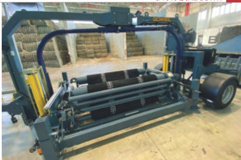
del film plastico. Solo a quel punto, per questioni di sicurezza, l'operatore interverrà per azionare il comando di scarico della palla: una volta ribaltata la palla lateralmente, la tavola di filmatura ritornerà in posizione, pronta ad accogliere una nuova palla.
