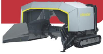
un modulo di separazione con aria forzata che estrae materiali ultraleggeri. Il sistema di dosaggio è costituito da un nastro trasportatore con angolo e con velocità variabile che trasporta il materiale sopra un'ansa fino a 4 m/s in modo da creare un momento di sospensione al punto di separazione, il cosiddetto SpeedCon. Mentre il DiscSpreader, quindi il distributore a dischi, distribuisce il materiale in maniera ottimale per l'intera ampiezza del nastro trasportatore.
