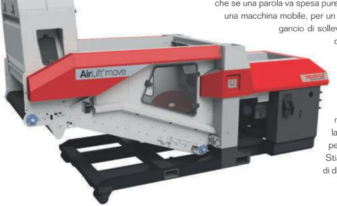
sicurare una maggiore efficienza rispetto ai tradizionali sistemi di estrazione tramite overbelt o ventilatori sopranastro e una purezza elevata fino al 99% grazie alla precisa regolabilità dei flussi di aria, oltre che un rendimento massimo fino a 120 mc/h a seconda del materiale.
