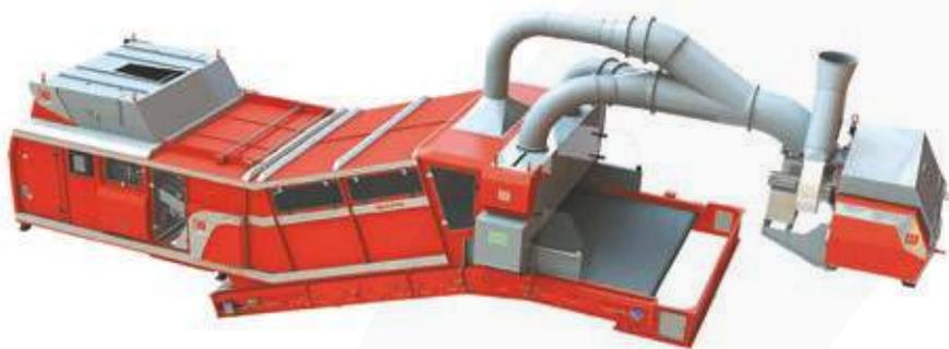
AirStar® con integrato DiscSpreader® e AirLift per separazione a 3 frazioni (pesante, leggero e ultraleggero)
