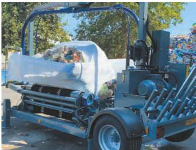
La filmatura di una palla "quadra" di rifiuto
