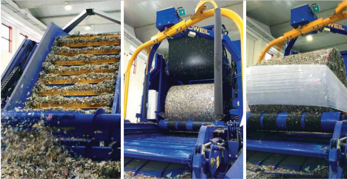
La Lt Master realizza balle cilindriche e le filma con pellicola multistrato. La rapidità con la quale i vari passaggi si susseguono è dovuta ad una precisa e ben studiata automazione dei processi che, unita ad un'alimentazione costante e adeguata, permette alla Lt Master di realizzare fino a 40/50 balle/ora
