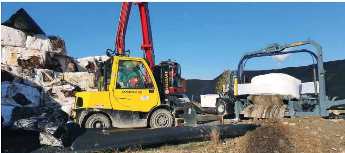
Come la Lt Master, anche la G4010Q Industry si distingue per la velocità di lavoro e per la flessibilità di settaggio dei vari parametri: il numero di giri di filmatura, così come il livello di sovrapposizione del film plastico, possono essere modificati in ogni momento, secondo esigenze e necessità
