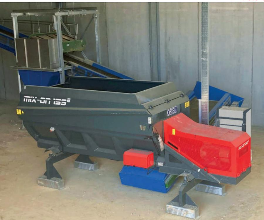
sulle sue pale, si ottiene una doppia azione contemporanea di **taglio/strappo**. La miscelazione avviene già tra le pale stesse del rotore e non solo all'interno della vasca.
