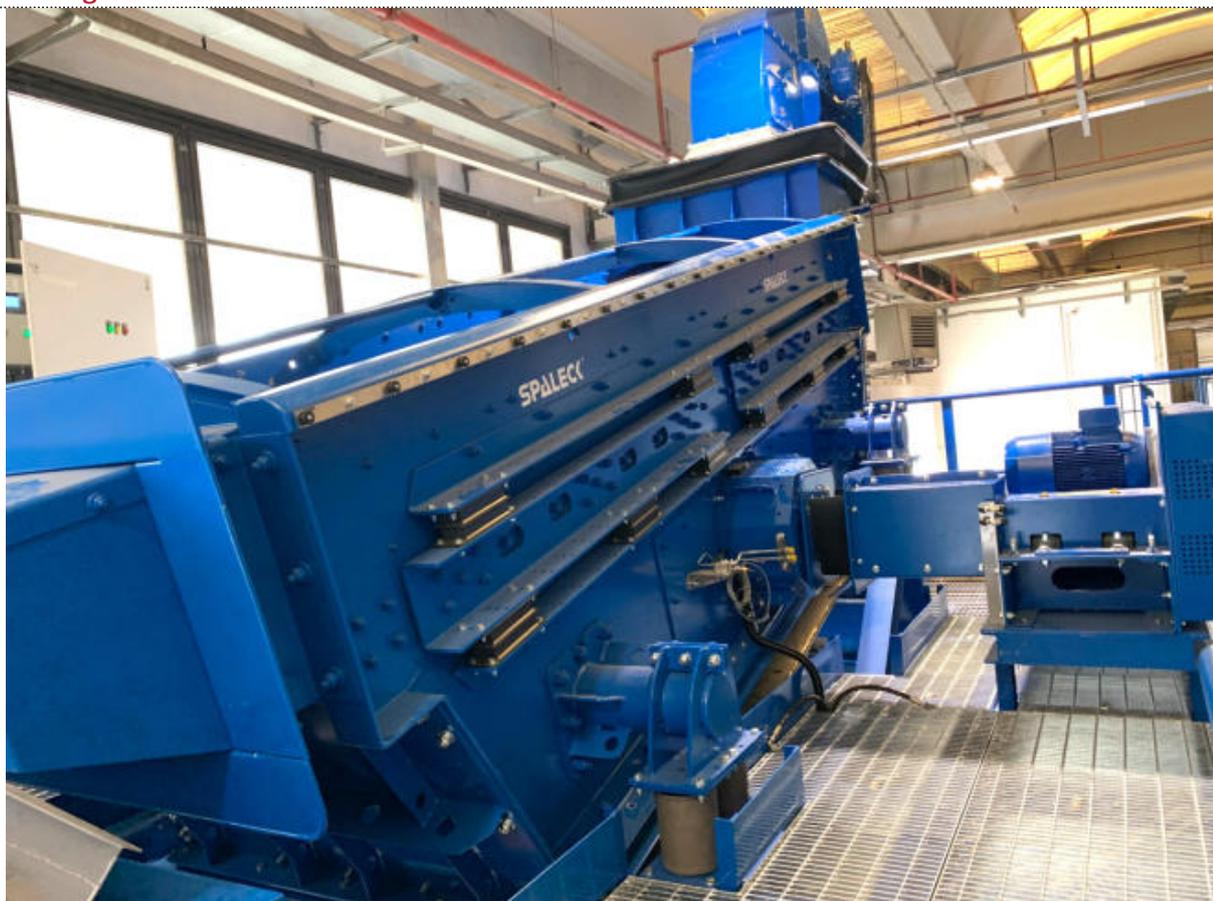
quindi separato alla massima efficienza: <4 mm (frazione polverosa), frazione media valorizzata, frazione di sopravaglio da riciclo. Il primo piano è in pannelli in acciaio con foro a sezione quadra 60x60 mm 3D (produzione speciale Spaleck), mentre il piano inferiore è
