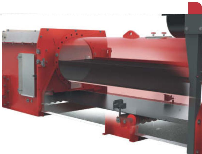
Tra i vari nastri trasportatori, meritano una particolare attenzione i PipeCon, nastri che viaggiano su cuscinetti d'aria all'interno di tubi di acciaio. Si tratta di un sistema di trasporto materiali "sigillato" che permette di attraversare lunghi tratti in sicurezza
