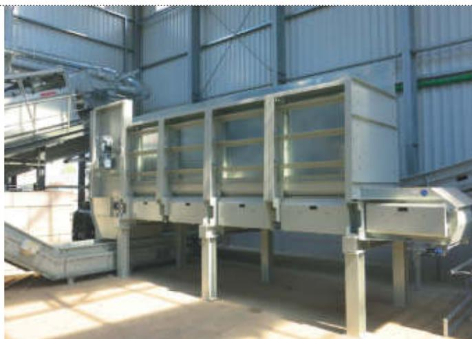
Infine Westeria è molto conosciuta anche per le varie tramogge di carico e di dosaggio “bunker system” in grado di soddisfare volumetrie addirittura pari a 600 m<sup>3</sup>.
