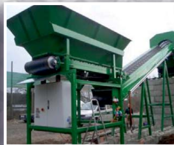
tramoggia di alimentazione
